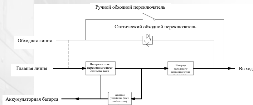
Рис. 1-4 Схема работы в стандартном режиме
