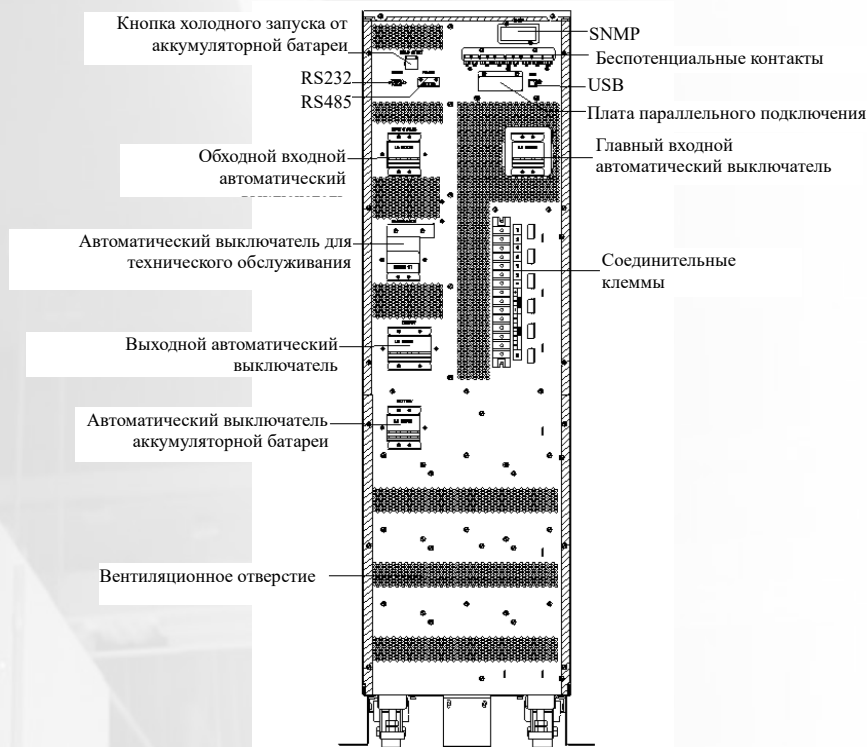
(е) Детальный вид сзади ИБП мощностью 20 кВА и 30 кВА со стандартным временем автономной работы
