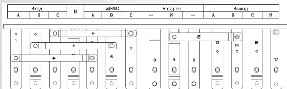
Рис. 2-15 Клеммы подключения ИБП мощностью 80 кВА / 100 кВА
