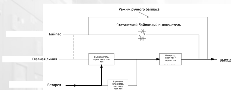
Рис. 1-6 Схема работы в режиме питания от батарей
