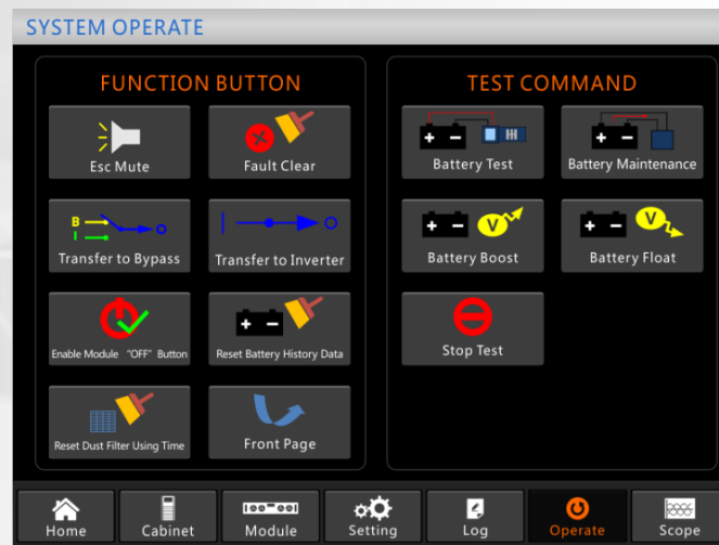
Рис. 4-3 Техническое обслуживание батареи
