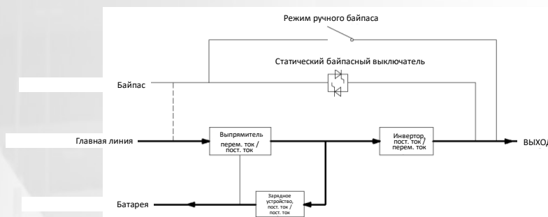
Рис. 1-5 Схема работы в нормальном режиме
