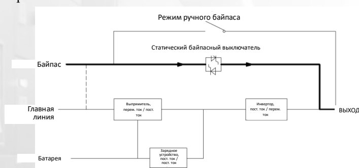
Рис. 1-7 Схема работы в режиме байпаса
