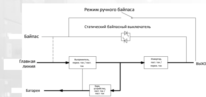
Рис. 1-5 Схема работы в нормальном режиме
