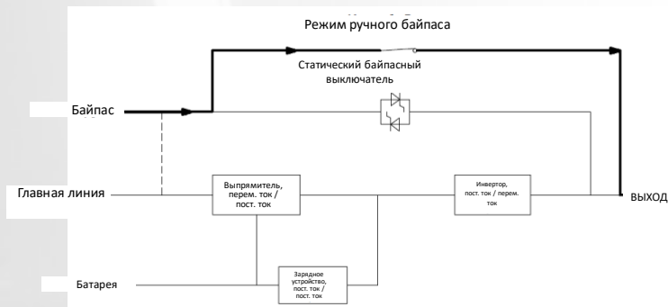
Рис. 1-8 Схема работы в режиме технического обслуживания
