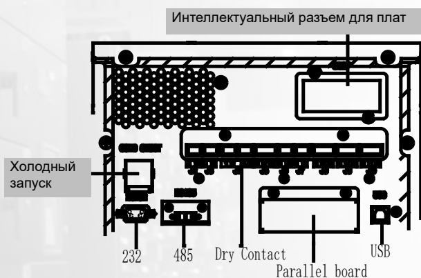
Рис. 3-13 Интерфейс беспотенциальных контактов и интерфейс связи
